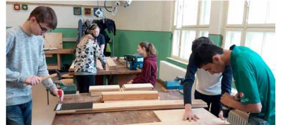
Im März und April 2019 fanden zwei Workshops mit den BAUFACHFRAUen statt, in denen die ersten Pflanzkübel aus Lärchenholz entstanden. Es wurde gemessen, gebohrt und geschraubt, manchmal kam auch die Stichsäge zum Einsatz. Im Anschluss wurden die fertigen Behälter mit einem speziellen Wetterschutzöl behandelt, um das Holz zu schützen und in seiner hellen Farbe zu erhalten.
